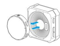
将TX从RX上取出, TX与RX都将自动开机并配对; 将TX放入RX, TX将自动关机进行充电
