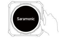
长按RX电源键3秒,RX开机的同时将唤醒TX并自动配对
