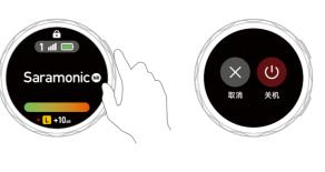
长按电源键3秒,点击"()"确认将TX关机
